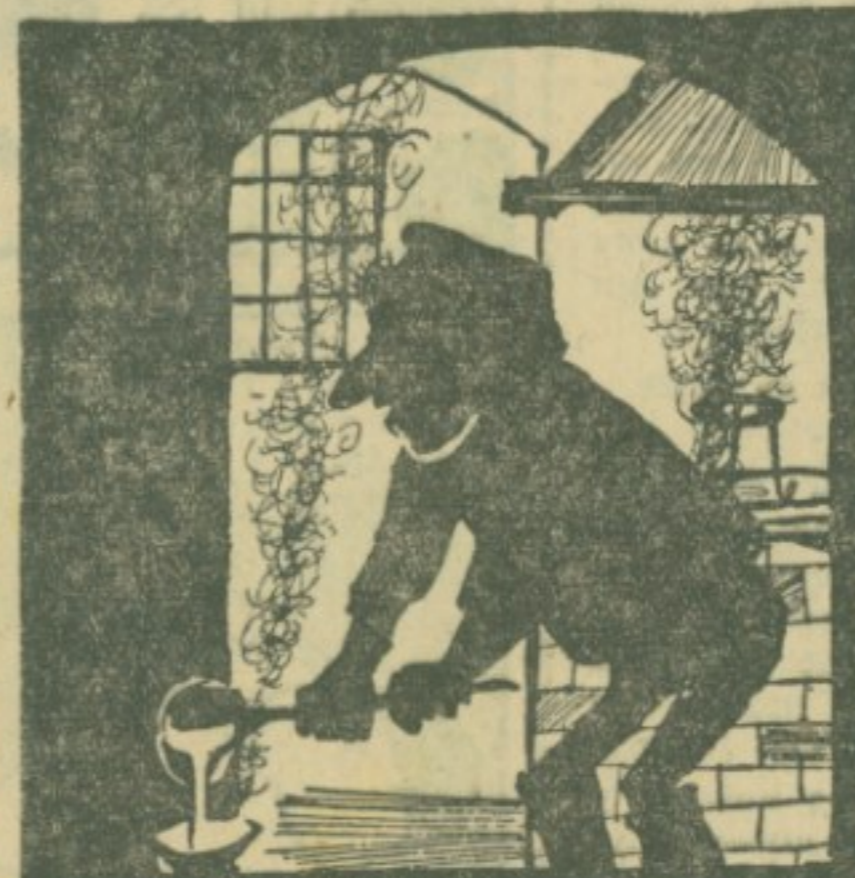
1829 Клод Жену, из Лиона, пронашао је стереотипију (изливање течност олова на релефни картон). Овај поступак омогућио је да се новине штампају помоћу ваљка, огромном брзином.
