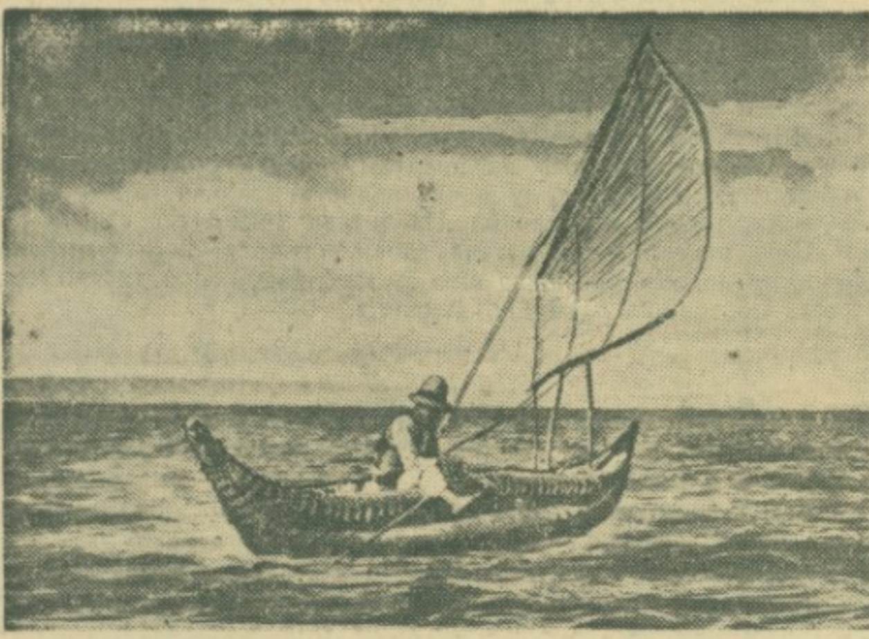
На језеру Титикака, са надморском висином 3.854 метра, на Андима између Боливије и Перуа, употребљавају се чамци направљени од траве са једрима од трске. Човек у чамцу управља веслом које је испод његове десне ноге. Ова врста чамца зове се „балса“, ваљда по истоименом дрвету, од кога се праве сплавови за дуга путовања.
