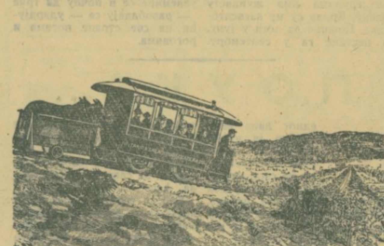
ТРАМВАЈ НА И ЗА МАЗГЕ. У ГРАДУ ОНТАРИО (САН БЕРНАРДИНО КАУНТИЈИ У КАЛИФОРНИЈИ) ПОСТОЈАЛА ЈЕ 1890 ГОДИНЕ 6,3 МИЉА ДУГА ТРАМВАЈСКА ПРУГА. ЈЕДАН ЊЕН ДЕО ВОДИО ЈЕ УЗБРДО, ДРУГИ НИЗБРДО. ТРАМВАЈ СУ УЗБРДО ВУКЛЕ МАЗГЕ, А НИЗБРДО СУ СЕ ОНЕ ПРЕТВАРАЛЕ У ПУТНИКЕ, СТАВЉЕНЕ СУ У ПОСЕБНУ, ПОЗАДИ ТРАМВАЈА ПРИКАЧЕНУ ПРИКОЛИЦУ.
