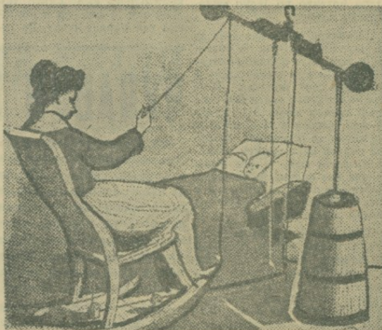
ИДЕЈА ИЗ АМЕРИКЕ: СТОЛИЦА ЗА ЉУЉАЊЕ КАО ПОКРЕТАЧКА СНАГА ЗА КОЛЕВКУ И БУЉКАЛИЦУ ЗА МАСЛАЦ
