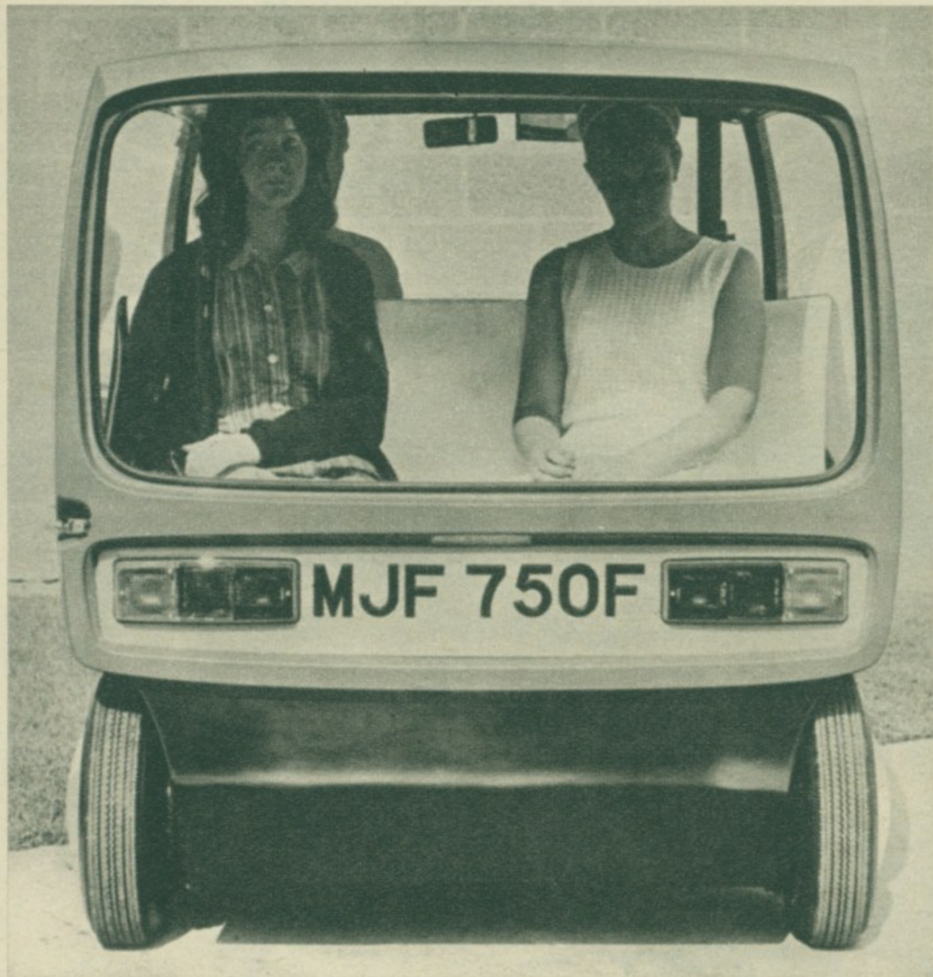
КОЛА ЗА ЗАКРЧЕНЕ УЛИЦЕ. — Бивши британски пилот Мајк Форест конструисао је аутомобил за 4 особе (седе окренуте леђима) који је дугачак свега 180 а широк 140 сантиметара. Врата се налазе на предњој и задњој страни мини-аутомобила. Све команде, као и волан, у једној су полузи.
