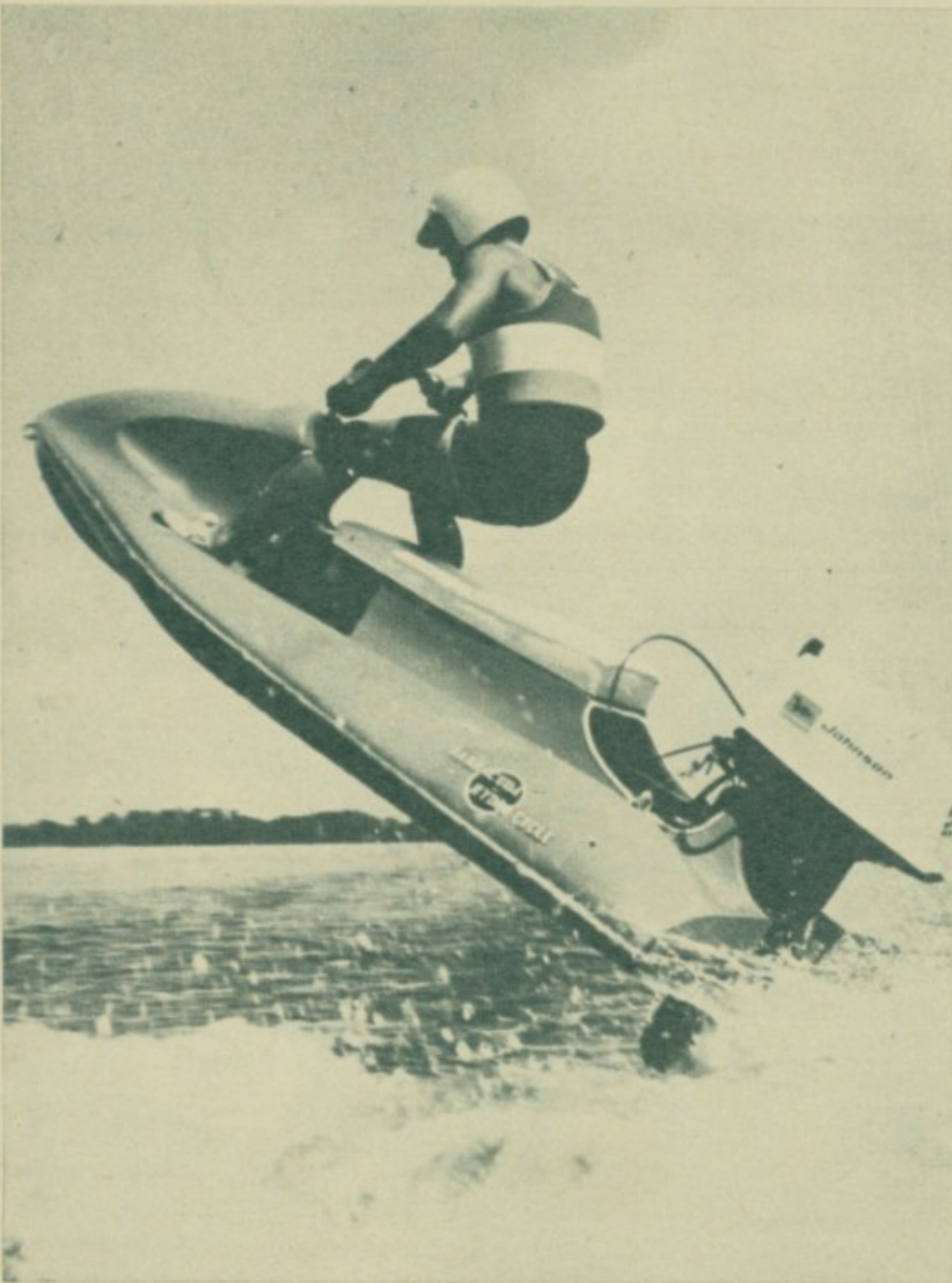
ХИДРОЦИКЛ. — На плажама Флориде појавила се нова врста супербрзих чамаца названих „баракуда хидроцикл“. Чамац има равно дно и ванбродски мотор а управљач и седиште су му као код мотоцикла. У пуној брзини готово не додирује воду.
