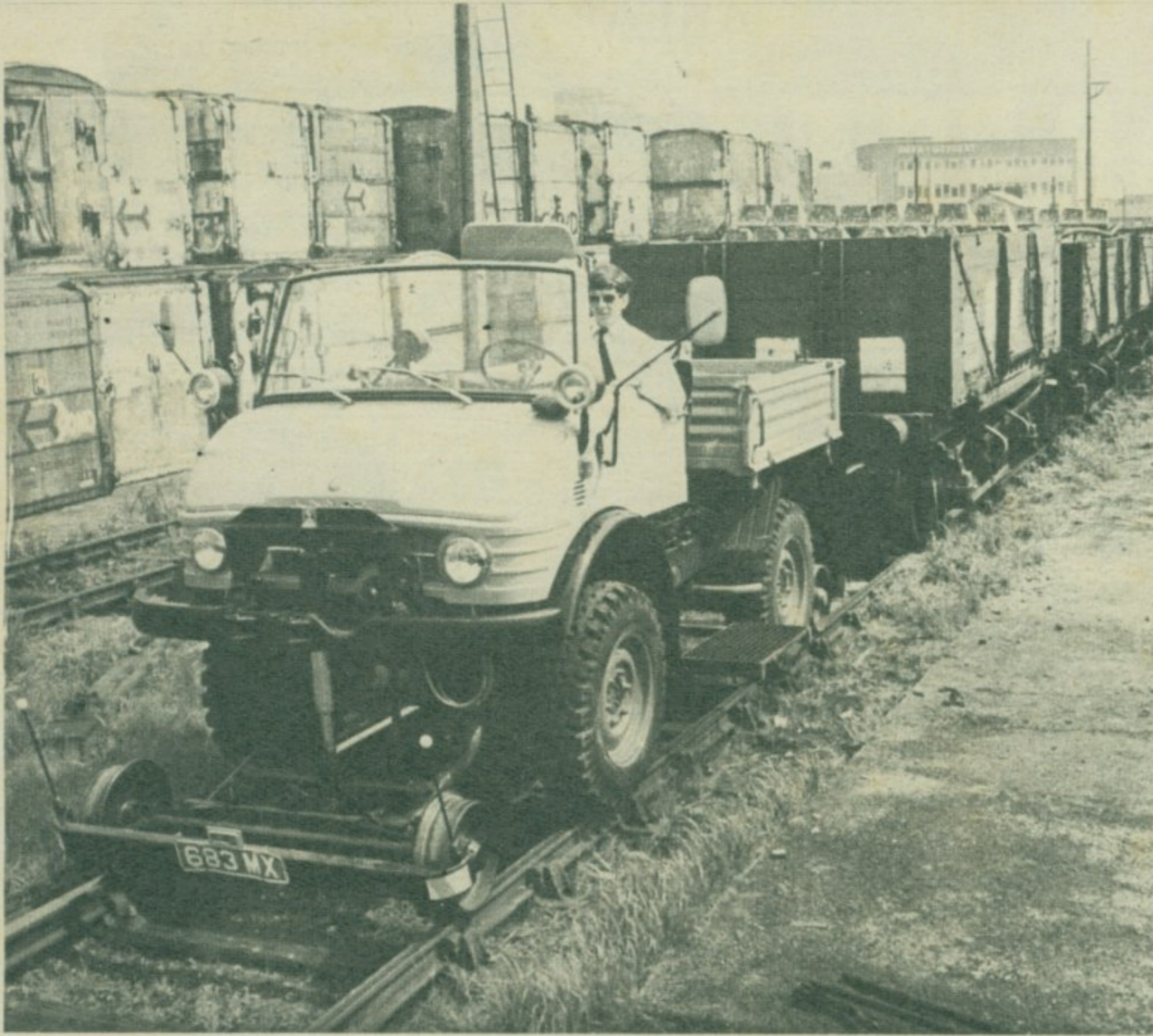
АУТОМОБИЛ И ЛОКОМОТИВА. — Недавно је у Кју Бриџ Сауту, у Енглеској, испробано ново возило које је истовремено и аутомобил и локомотива. Када је на шинама ово возило са 8 точкова, које је израдила позната фирма Мерцедес-Бенц, може да вуче терет од 300 тона. Измена точкова је једноставна и обавља се помоћу једног хидрауличног механизма. Аутомобил-локомотива добио је име УНИМОГ.
