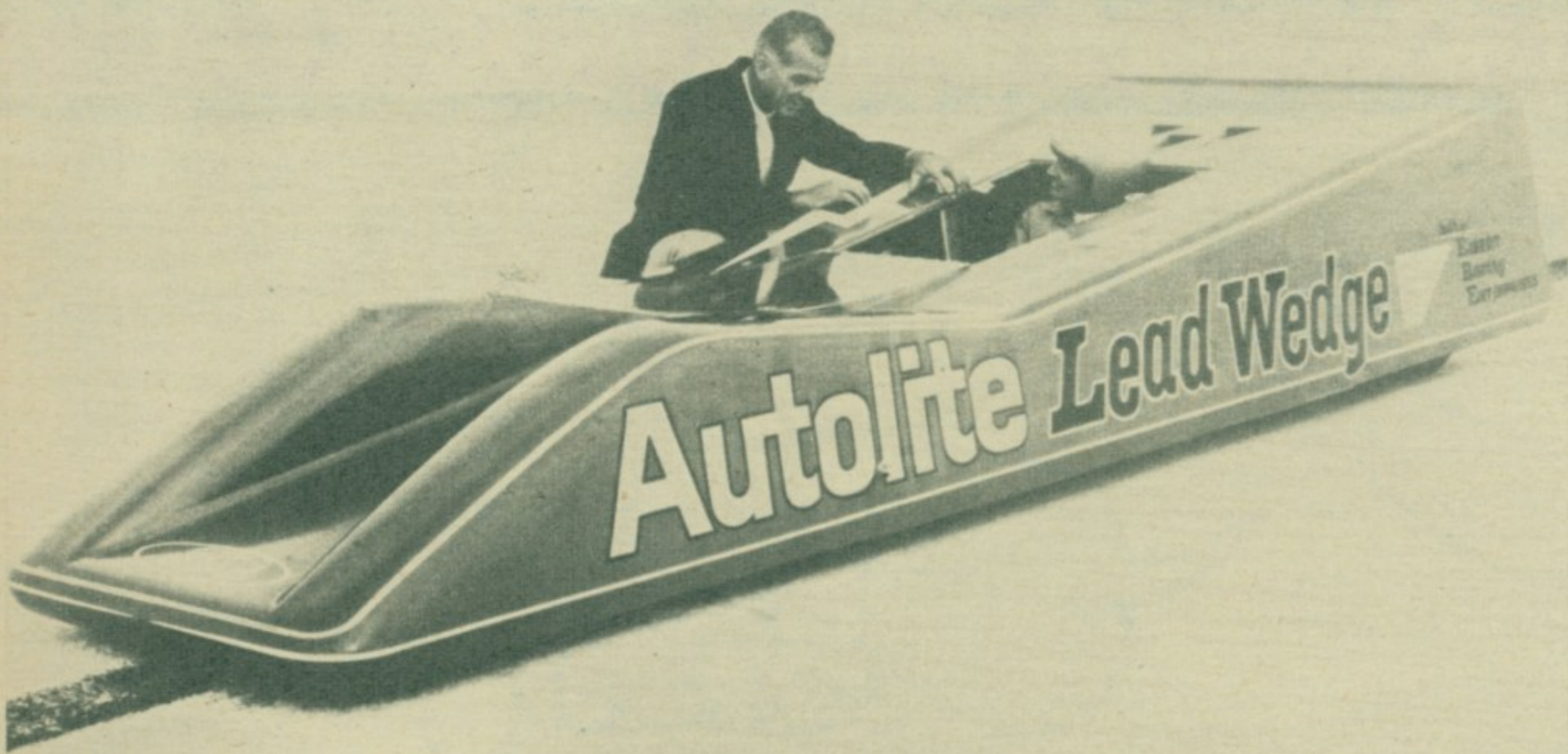
ЕЛЕКТРИЧНИ ТРКАЧКИ АУТО. — Двадесет батерија напаја електрични мотор овог необичног возила клинастог облика. Аутомобил постиже брзину од око 210 километара на час, дугачак је четири метра, а шасија му је од алуминијума. Двадесет деветогодишњи возач Џери Кугел, који верује да је аутомобил на електрични погон возило будућности, прима последња упутства од инструктора на пробној писти Боневил Солт Флетса у Утахи, САД.
