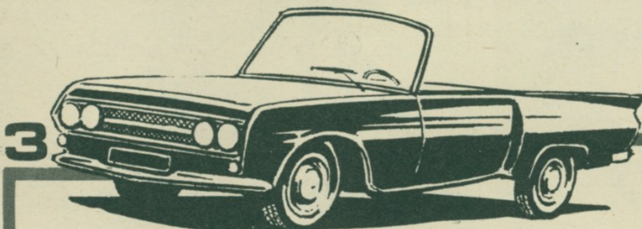
3 Аутомобил назван „Лена“, покреће га мотор од 1000 кубика, има покретан кров, развија брзину од 100 км на час. Рад механичара из Москве.
