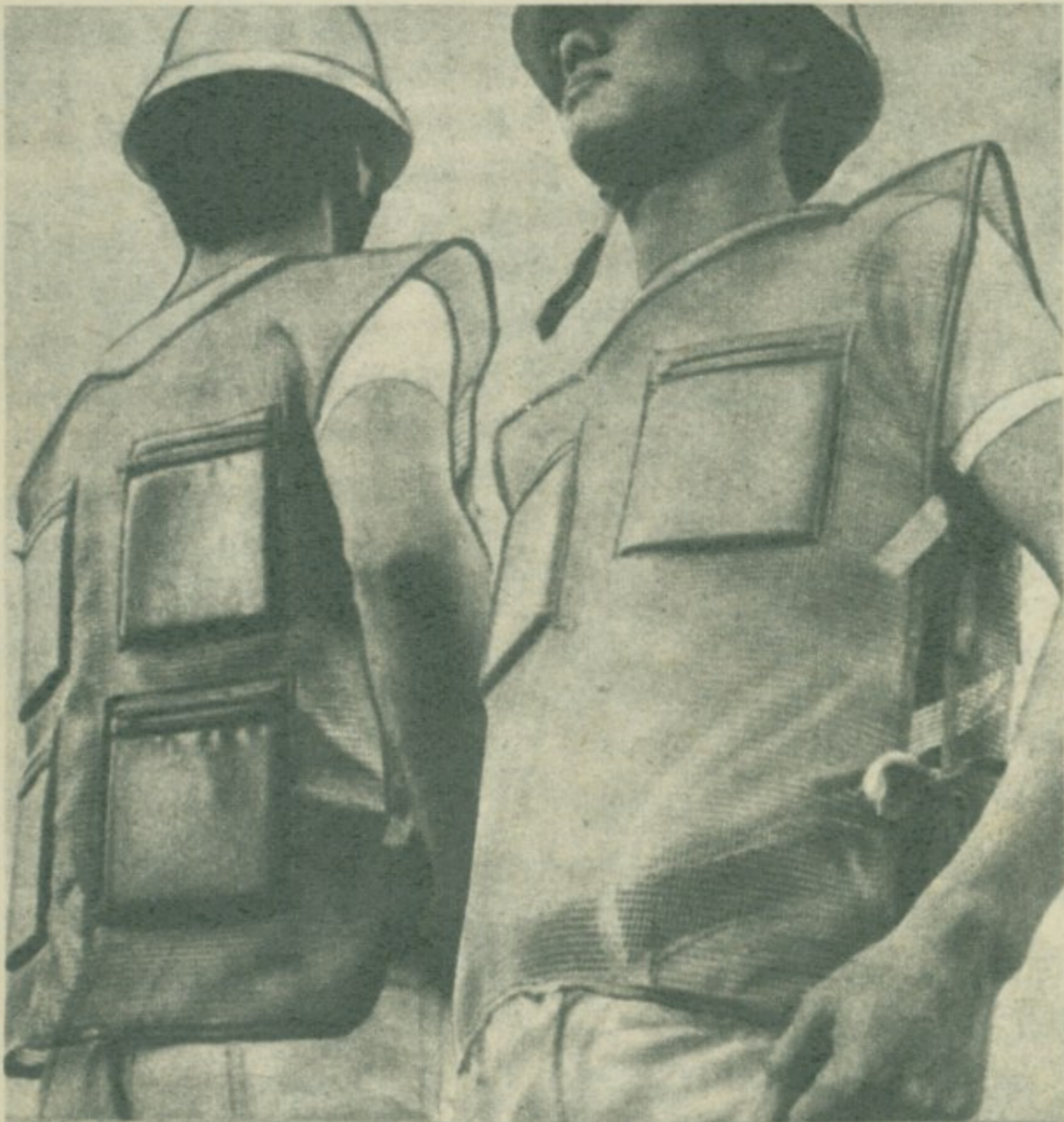
ФРИЖИДЕР У ПРСЛУКУ. — Прслук за хлађење радника у челичанама и бродским котларницама испробан је у Јапану. Плочнице сувог леда распоређене у шест џепова мрежастог прслука израђеног од винил-хлоридних влакана, расхлађују ваздух у „окцима“ мреже и тиме подижу радну способност за десет одсто.
