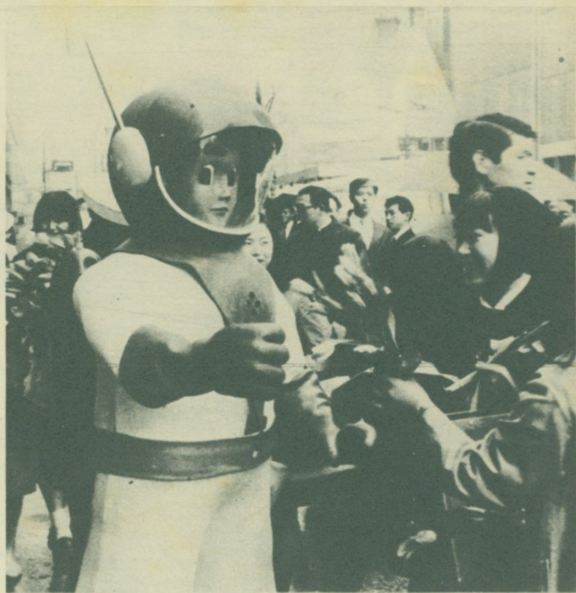
ГОСТОЉУБИВИ РОБОТ. — Еспер је робот који има изглед човека, висок је два метра и тежак 120 кг. На овогодишњем међународном сајму у Токију он ће дочекивати посетиоце. Еспер уме да говори и може да изведе 28 различитих покрета. Креће се захваљујући даљинском радио-управљању и преваљује 4 километра на час. Потпуно је у духу времена: одевен је као космонаут.
