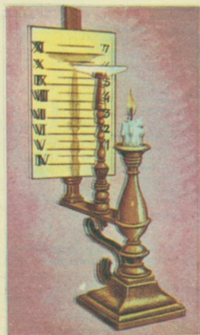
10 САТ — СВЕЋА — Овај изум који се приписује енглеском краљу Азареду Великом био је у употреби од средњег века па све до 1700. године из које је и модел на слици. Сенка показује часове условљене брзином топлења свеће. Сат је непрецизан и пре је украс и извор светлости него показатељ времена.
