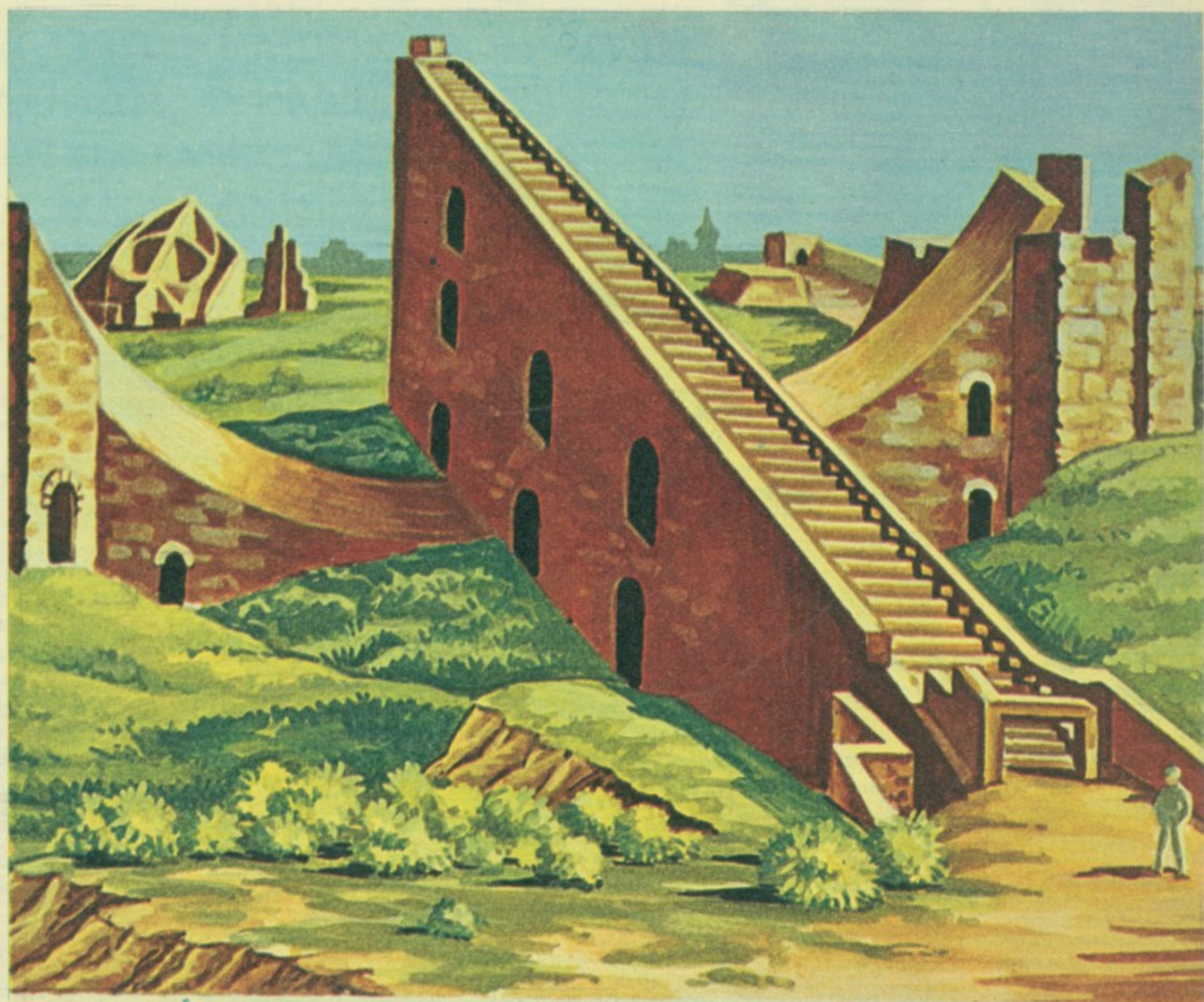
3 НАЈВЕЋИ НА СВЕТУ — Налази се у парку сунчаних сатова махараџе од Џајпура у Индији. Високе степенице, окренуте према Северњачи, бацају сенку на скалу која се налази испод и коју деле напола и на тај начин показују време. Прецизност сунчаних сатова зависи од величине предмета који баца сенку и стога су стари народи као „казаљку“ употребљавали високе обелиске.
