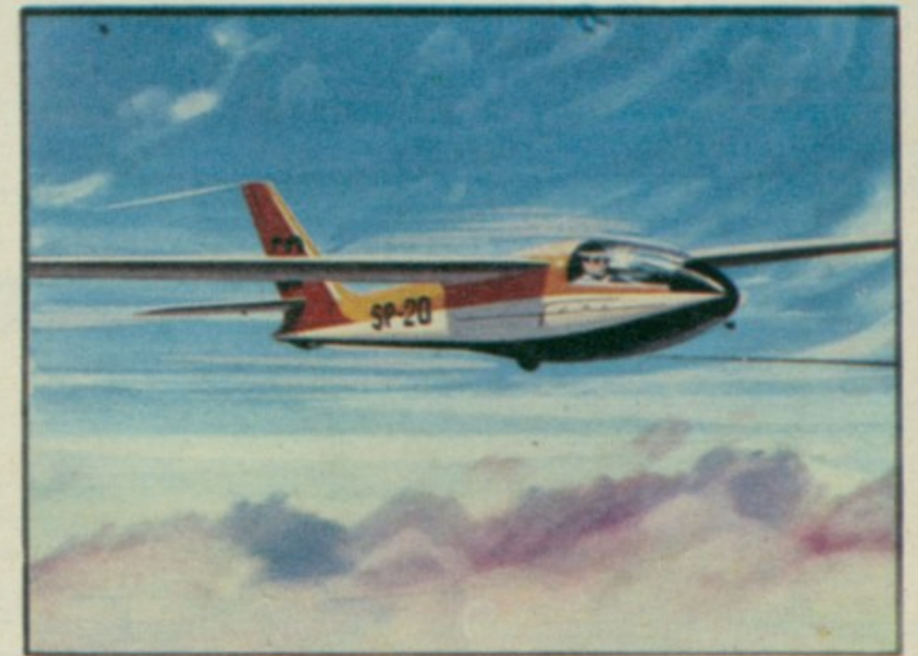
76. „ЕОЛ“ — Италијанска једрилица „Еол“ коју је пројектовао инжењер Бруни а направила фирма „Маркети“ одликовала се брзином која јој је омогућавала да побеђује на такмичењима на 100 и 200 км. Летелица је била једносед а пилот је управљао у полулежећем ставу.
