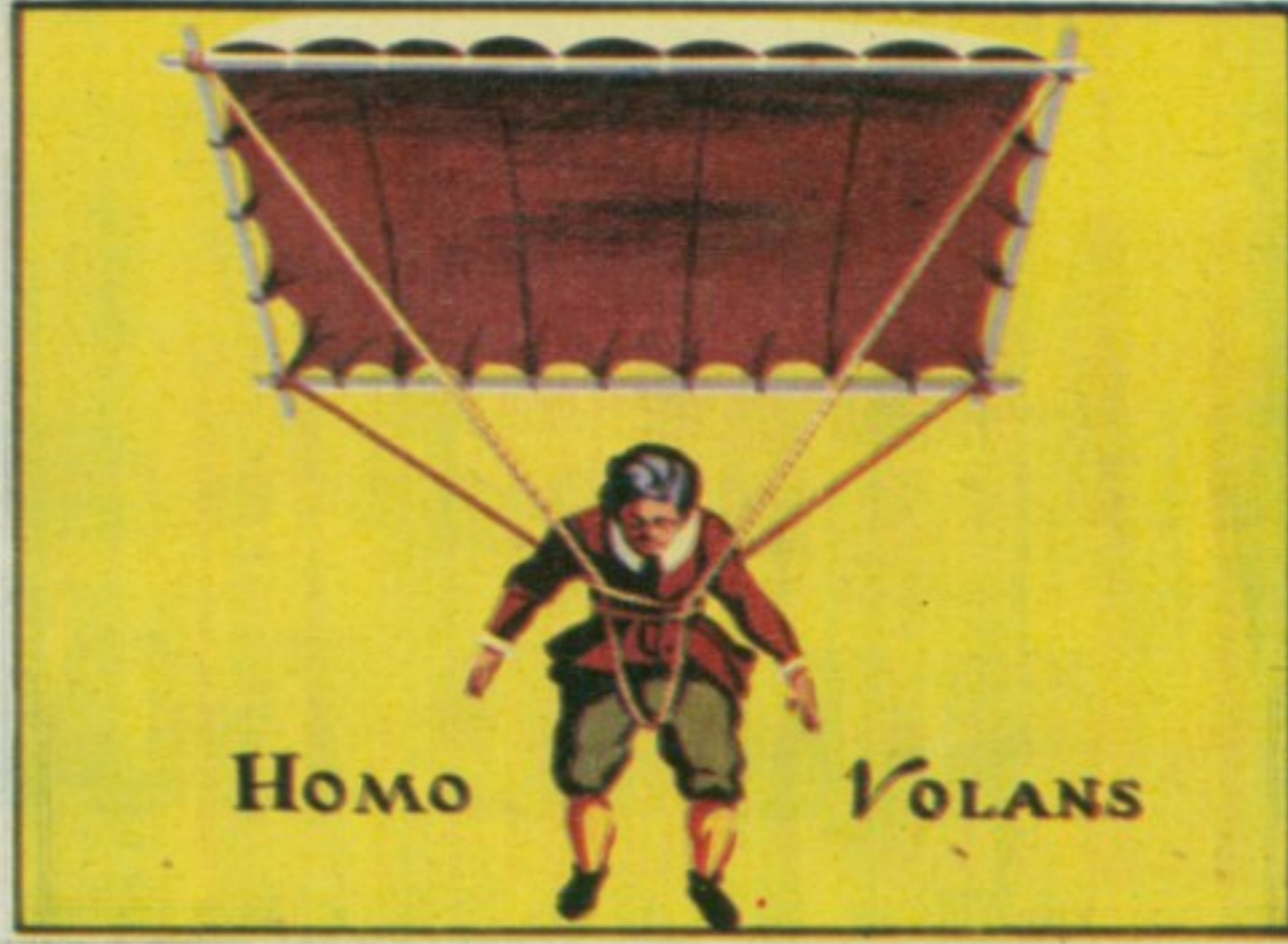
69. ПАДОБРАН — Настављајући студије Леонарда да Винчија о летењу, Шибенчанин Фаусто Вранчић који је учио у Падови дао је у својој књизи „Макине нове“ штампаној 1595. у Италији нацрт овог квадратног падобрана. Није познато да ли је Вранчић испробао свој изум.
