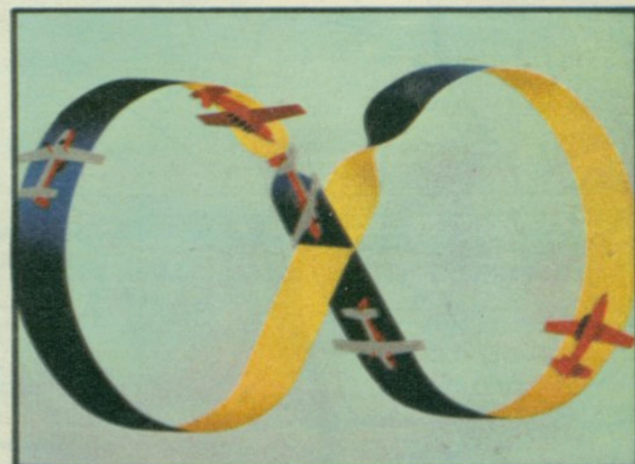
97. ОСМИЦА — Једна од најсложенијих акробатских фигура. Добија се комбинацијом два лупинга или петље обрнутог смера уз два превртања авиона око уздужне осовине. Осмица може да буде положена или усправна и када је добро изведена представља најлепшу фигуру у ваздуху.
