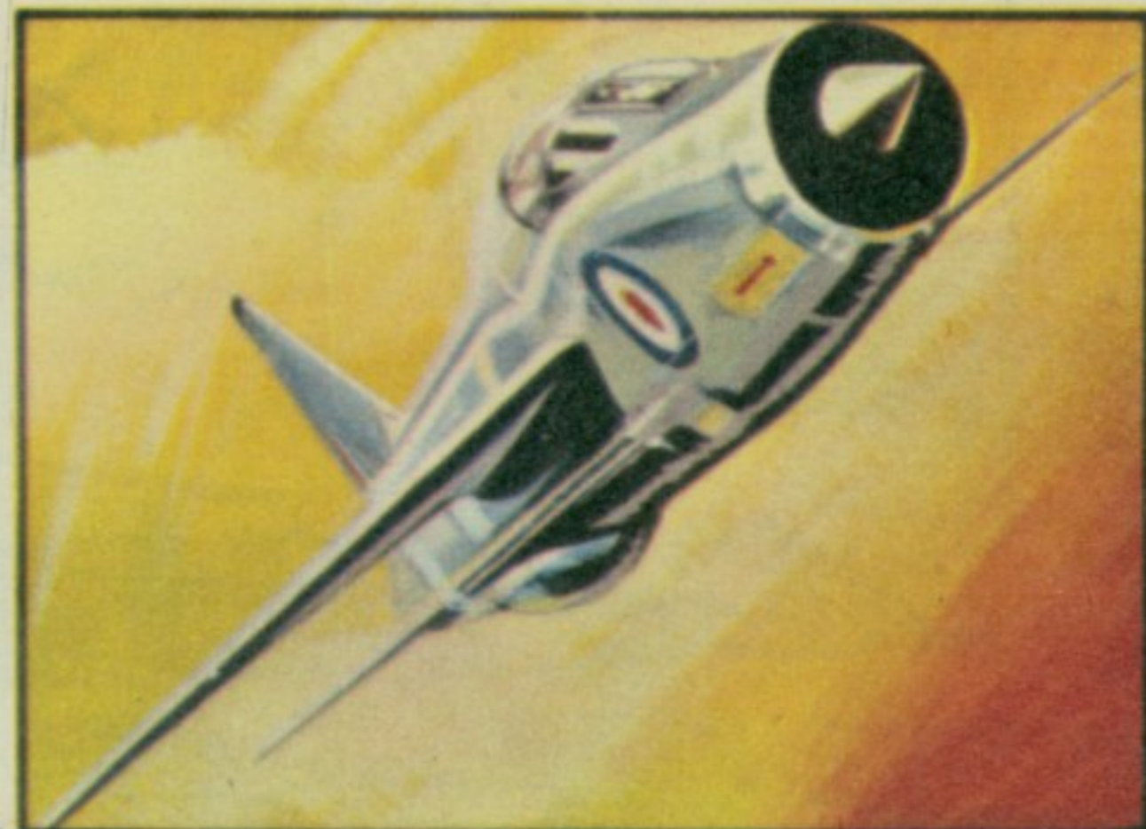
151. „ЛАЈТНИНГ“ — Од 1960. године па све до данас „Лајтнинг“ је најмодернији ловачки авион Британског краљевског ваздухопловства. Његова карактеристика је распоред мотора — један изнад другог. Последњи тип је „Ф-3“ с усавршеним радаром и опремљен ракетама типа „Ред топ“.
