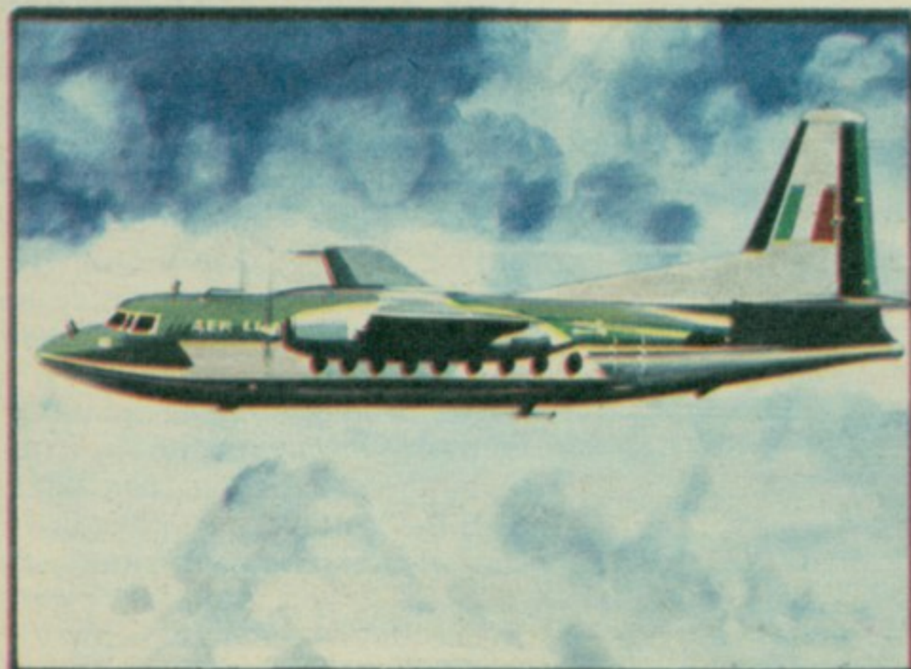
144. „Ф-27“ — Холандски путнички авион типа „Фокер“ познат је под именом „Пријатељство“. Овај двомоторац појавио се 1955. године и постигао такав успех да су га купиле готово све светске авионске компаније. Не спада у ред ваздушних цинова јер може да прими највише 40 путника.
