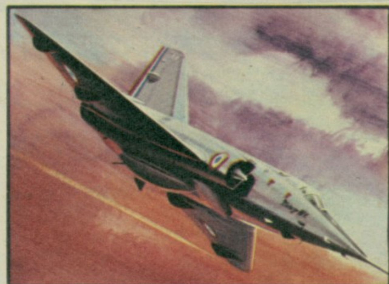
155. „МИРАЖ IV“ — Чувени француски млазни двомоторни бомбардер с троугластим, делта, крилима. Може да носи нуклеарну бомбу или ракету ваздух — земља с нуклеарном главом. Опремљен је електронским уређајима за ометање непријатељских ракета. Гориво прима и за време лета.
