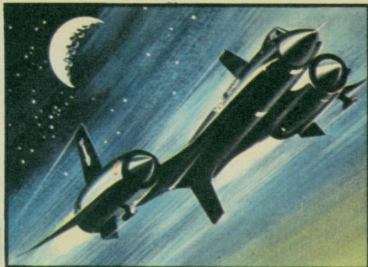
148. „А-11“ — Пројектован 1959. а први пут полетео 1964, овај амерички војни авион може да лети брзином равном трострукој брзини звука, односно око 4000 километара на час. Типови овог авиона су и ловац „Ф-12А“ као и „СР-71“, извиђач који може да носи и нуклеарну бомбу.
