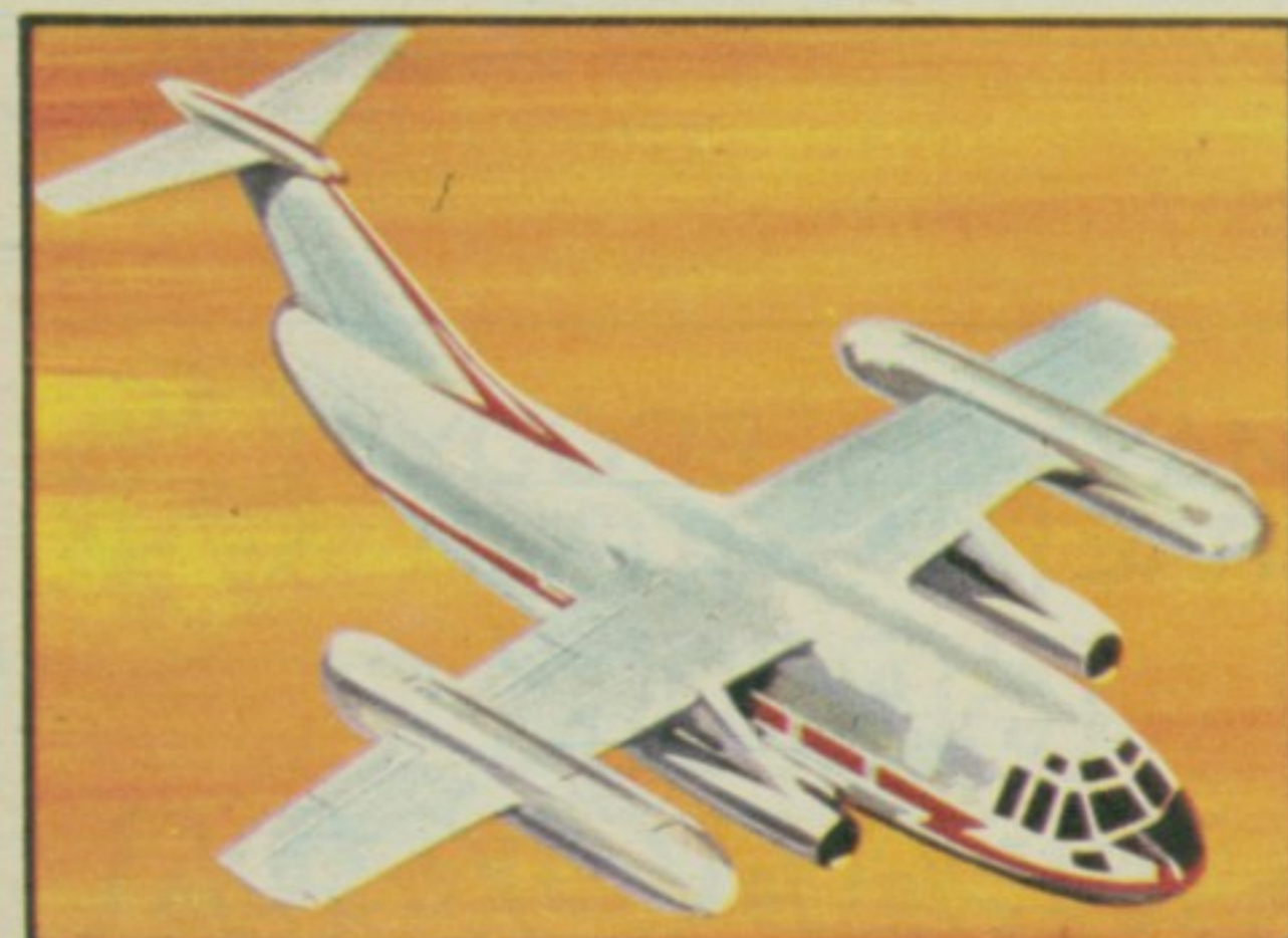
156. „ДО-31“ — Немачки прототип војног транспортног авиона с вертикалним узлетањем. Има два велика млазна мотора за хоризонтални погон и две групе мотора, вертикално монтираних у гондолама крила. Прототип је израдила фабрика „Дорније“ која се налази у граду Фридрихсхафен.
