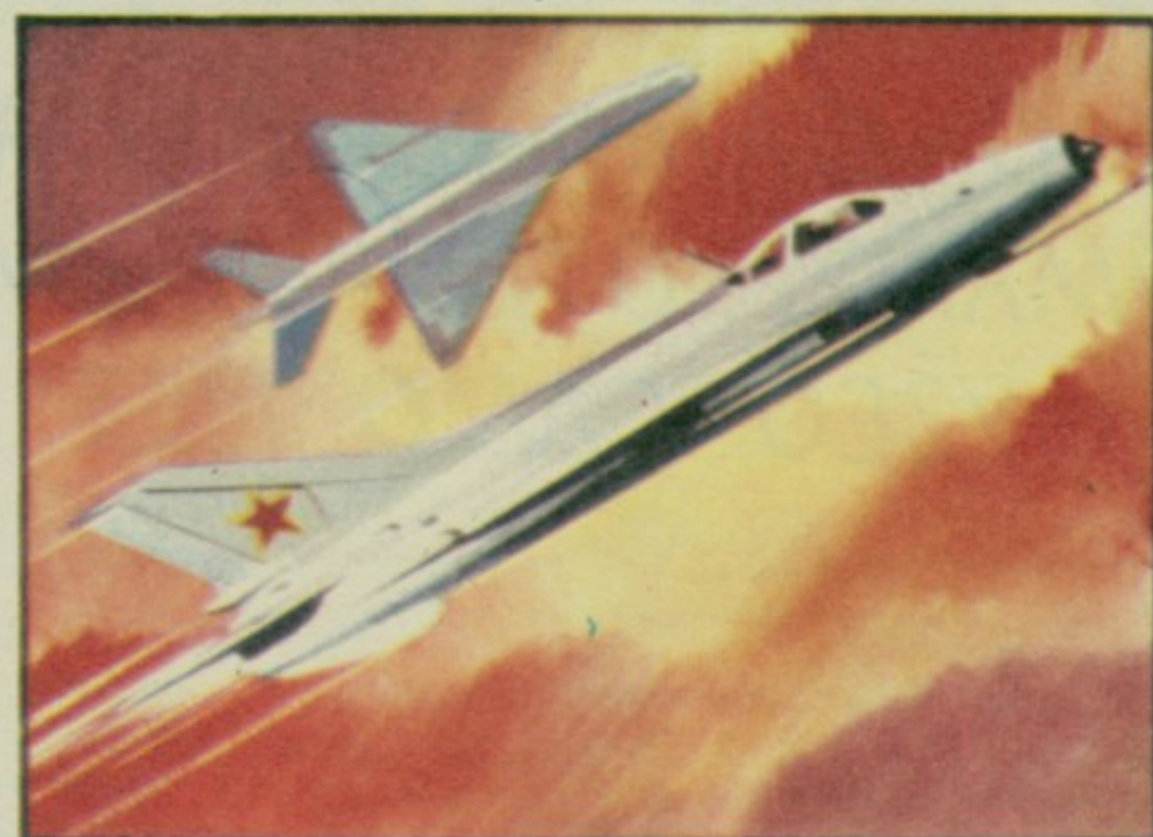
154. „МИГ-21“ — Модеран совјетски ловачки авион, једномоторни млазњак с троугластим крилима и стреластим стабилизатором. Постоје два типа од којих је један предвиђен за лов и извиђање а други за дејство и у најгорим временским условима. Извози се у многе земље широм света.
