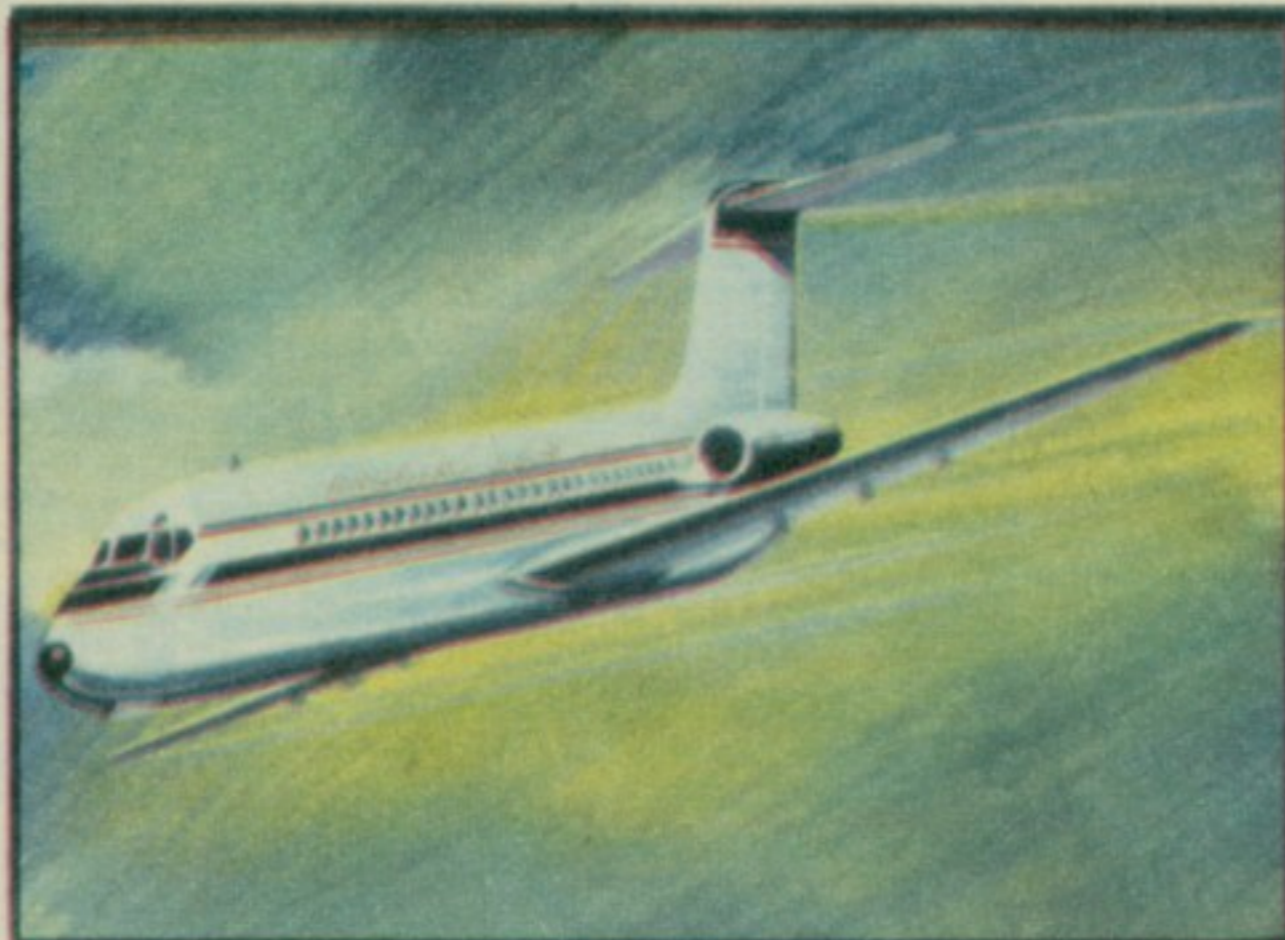
139. „ДЦ-9“ — Увођењем високоекономичних мотора постало је најзад могуће направити авионе који би се исплатили и на мањим растојањима. Тако се родила нова „генерација“ авиона двомотораца међу којима се истицао овај амерички, скраћеног трупа и с моторима уграђеним у репу.
