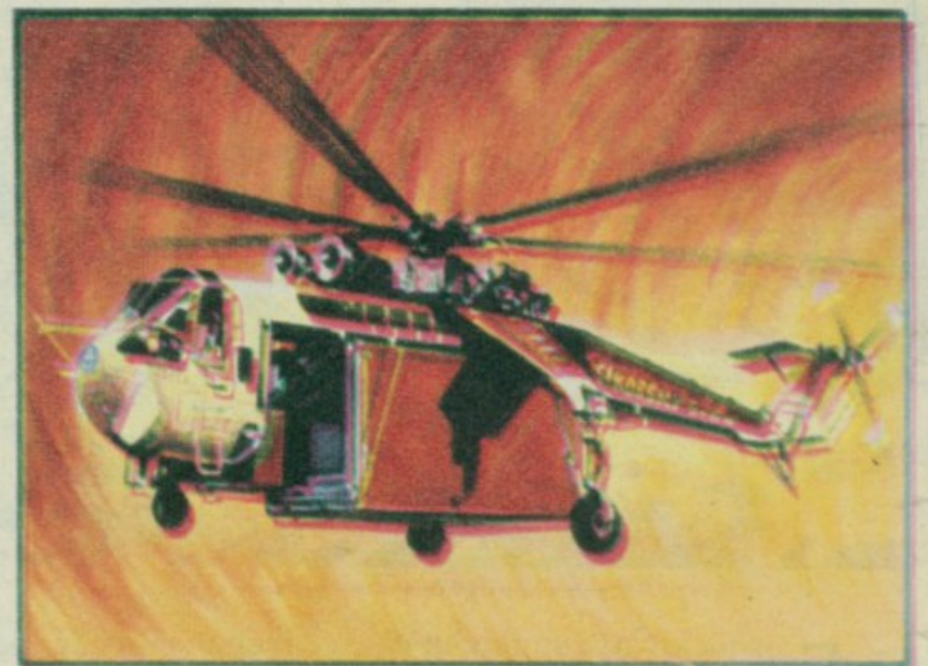
161. ЛЕТЕЋА ДИЗАЛИЦА — Амерички хеликоптер „Сикорски С-64“ служи за дизање веома тешких терета. У задњем делу пилотске кабине налази се још једно седиште окренуто супротно од правца летења а намењено човеку који маневрише теретом, слично као код обичних дизалица.
