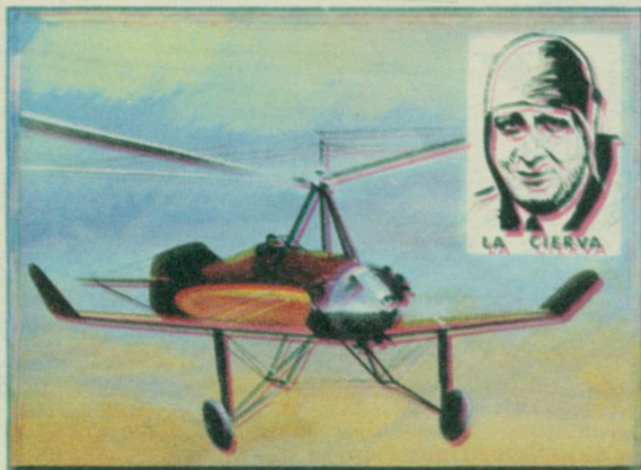
160. ДОН ХУАН ДЕ ЛА СИЕРВА — Ова необична летелица шпанског конструктора из 1928. имала је велики хоризонтални ротор у виду ветрењаче и представљала комбинацију авиона и хеликоптера. Аутожир је могао да узлети с веома кратке писте и да се спусти готово вертикално.
