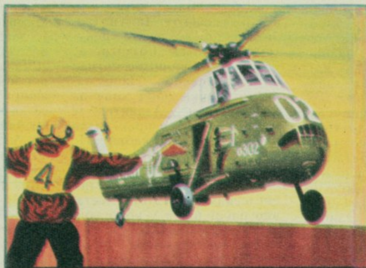
163. „ВЕСЕКС“ — Британски хеликоптер с једним ротором који покреће турбомотор. Употребљава се у енглеском војном ваздухопловству, нарочито за транспорт журишних трупа. Постоји више типова ове летелице а неки од њих имају примену у морнарици за борбу против подморница.
