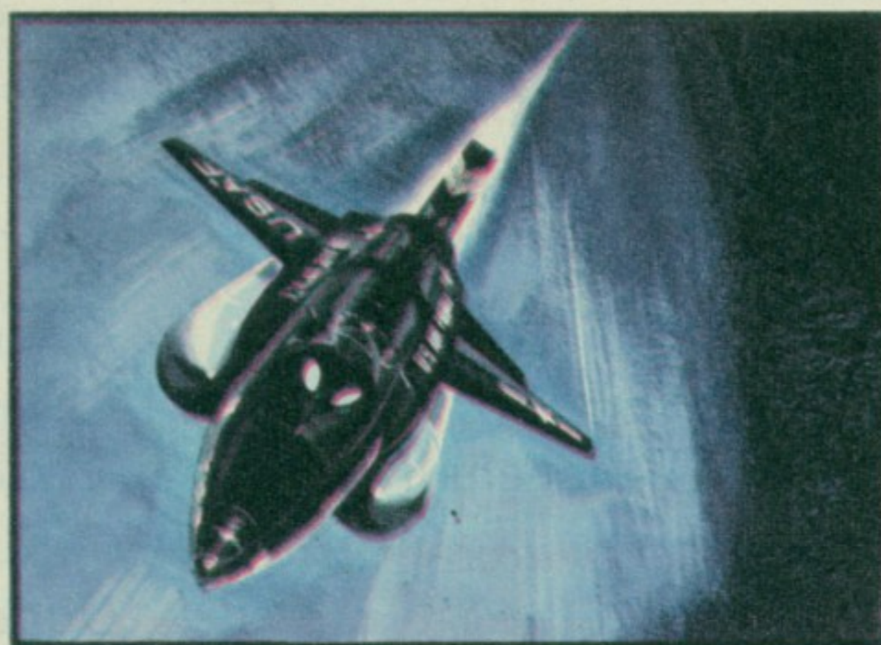
166. „Х-15А“ — Овај авион-ракета који се појавио на самом прагу астронаутског доба лети брзином од 8.000 км на час и то на висини од 150.000 м. „Х-15А“ вуче до одређене висине авион „Б-52“ а затим наставља сам своју фантастичну путању, покретан ракетним мотором.
