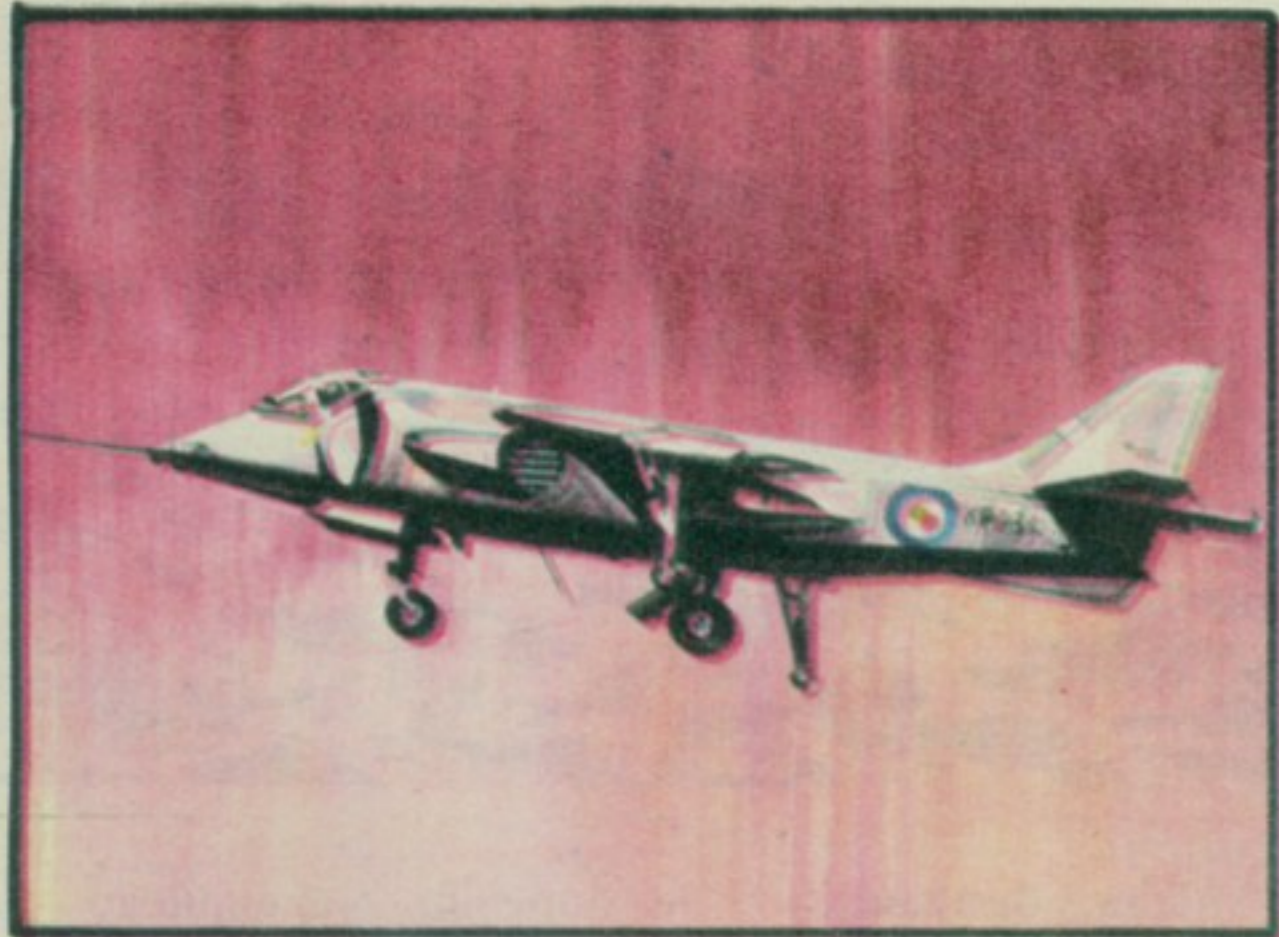
159. „П-1107“ — Британски „Хокер-Сидели“ П-1107“ је прототип једномоторног авиона с млазевима који могу да се усмеравају. Мотор, у ствари, има четири цеви, млазника, које могу да се обрћу тако да усмеравају потисак на доле за вертикалан или одостраг за хоризонталан лет.
