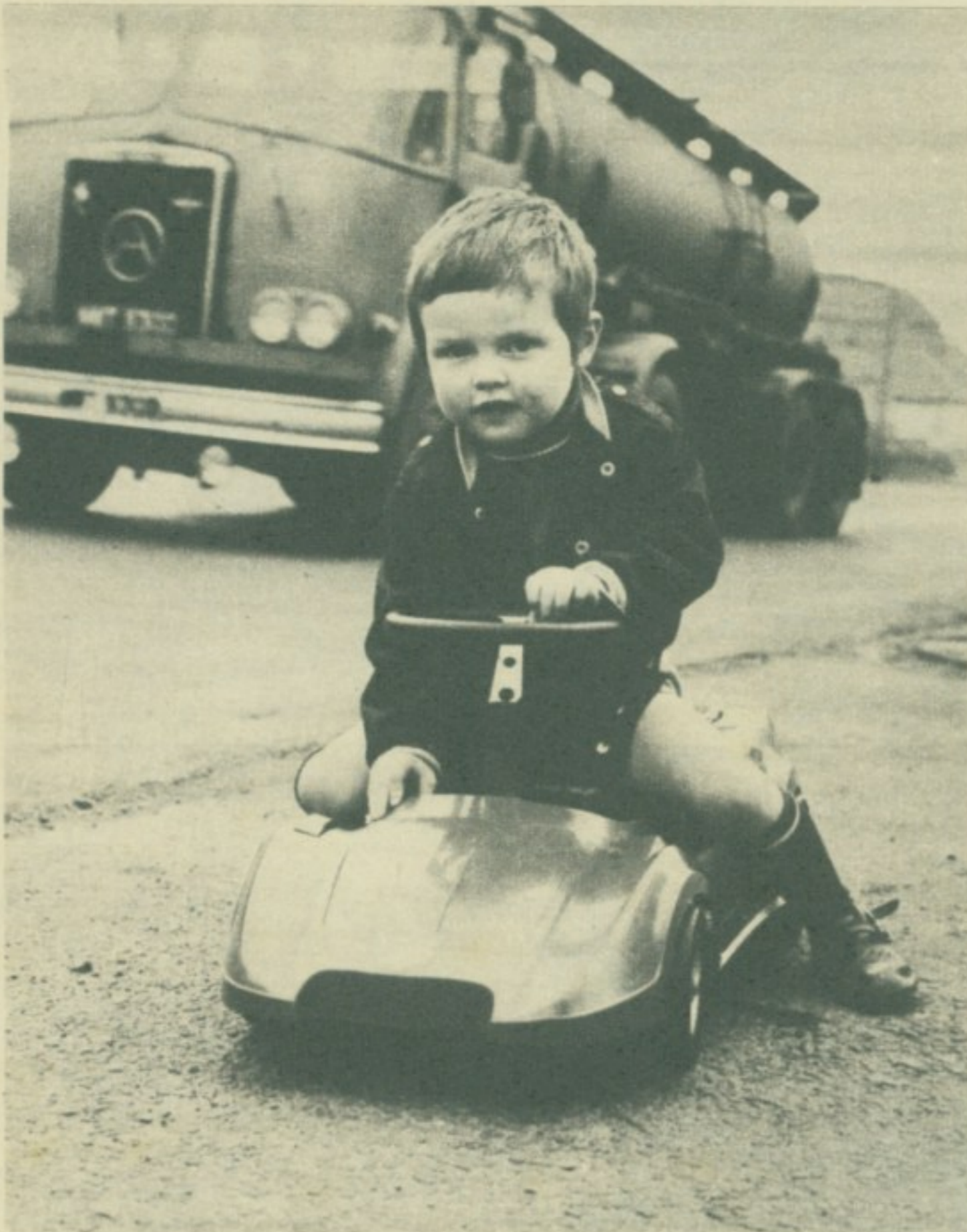
МИНИ-АУТОМОБИЛ. — Најновији британски мини-аутомобил са самосталним погоном висок је свега тридесет сантиметара и израђен је од појачане пластичне масе. Погонску снагу ова мала кола добијају од батерије од шест волти, могу да се крећу и уназад, а максимална брзина им је 3,5 километра на час.
