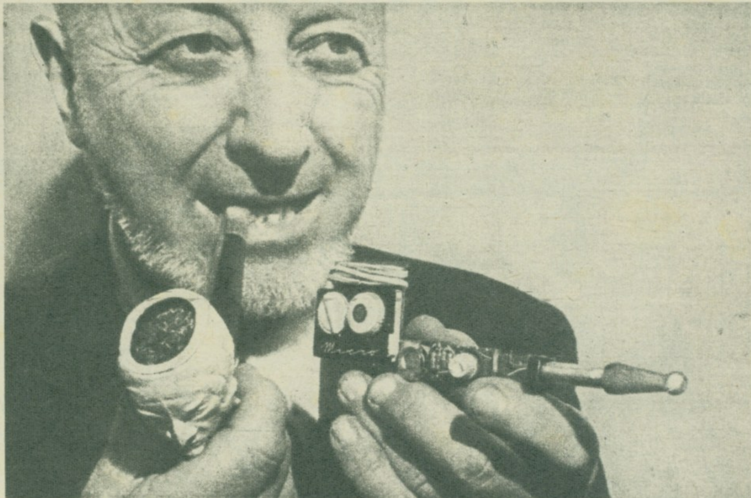
ЛУЛА ЗАМЕЊУЈЕ УХО. — Мали транзисторски радио-пријемник без гласноговорника, конструисан у Немачкој, омогућиће многим људима са оштећеним слухом да поново чују. Апарат, величине и облика луле за пушење, прима преко микрофона звучне таласе које кроз камиш преноси у унутрашњост уста. Преко вилчних костију таласи се даље преносе до слушних кошчица у средњем уху и до унутрашњег уха, односно до Кортијевог органа од којег полазе гране слушног нерва. Држећи ову лулу у устима gluва особа моћи ће да чује.
