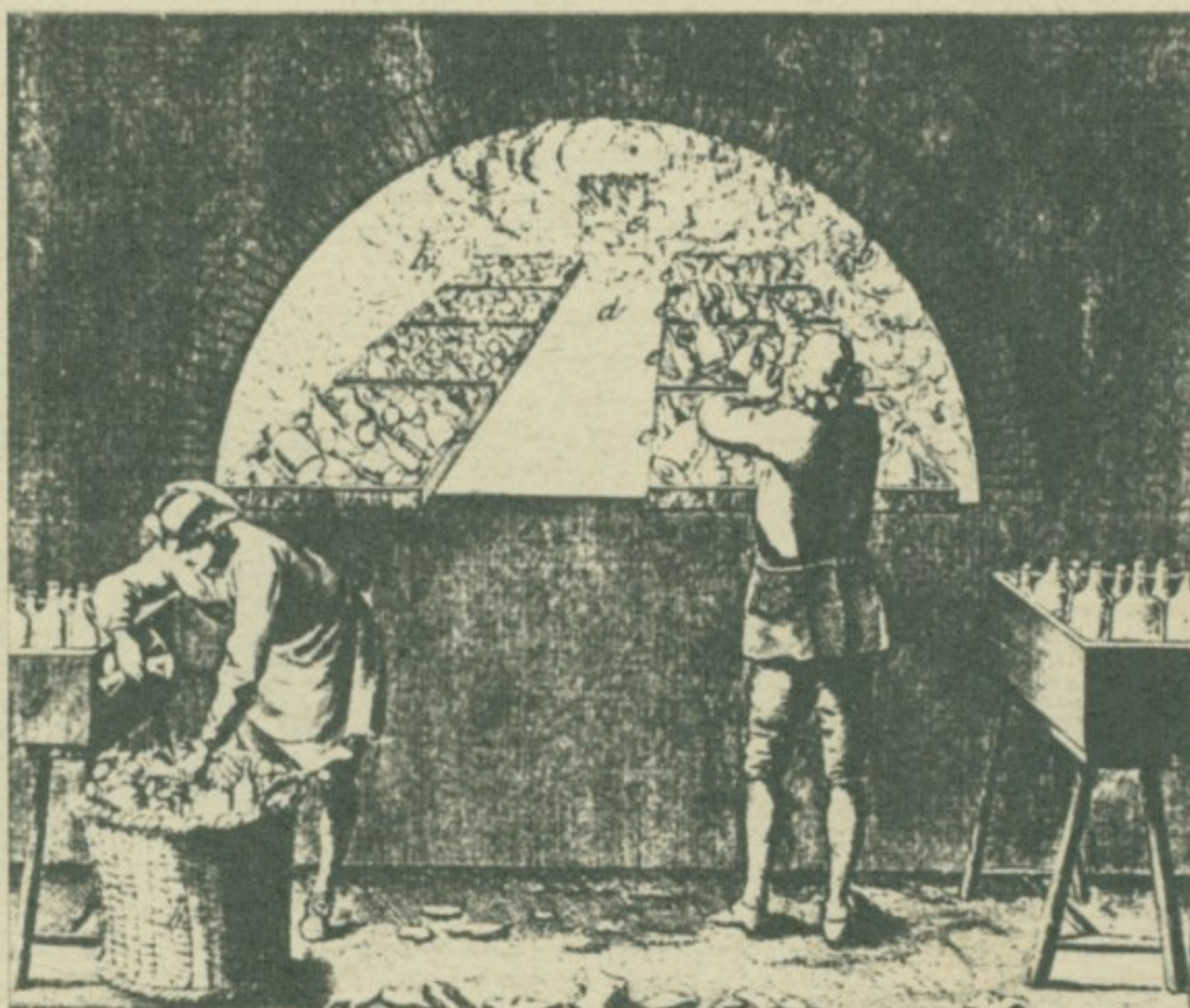
СТАКЛАРСКА ПЕЋ И ПРОИЗВОДИ СПРЕМНИ ЗА ПЕЧЕЊЕ (гравира из 18. века)
