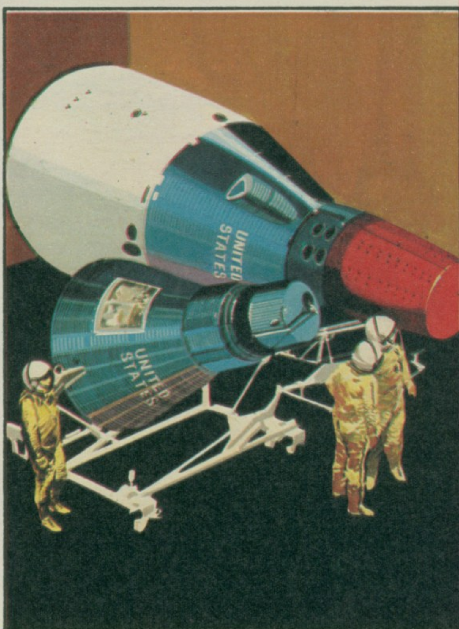
На слици су две напсуле: мања је једносед типа „меркјури“ а већа двосед типа „џемини“
