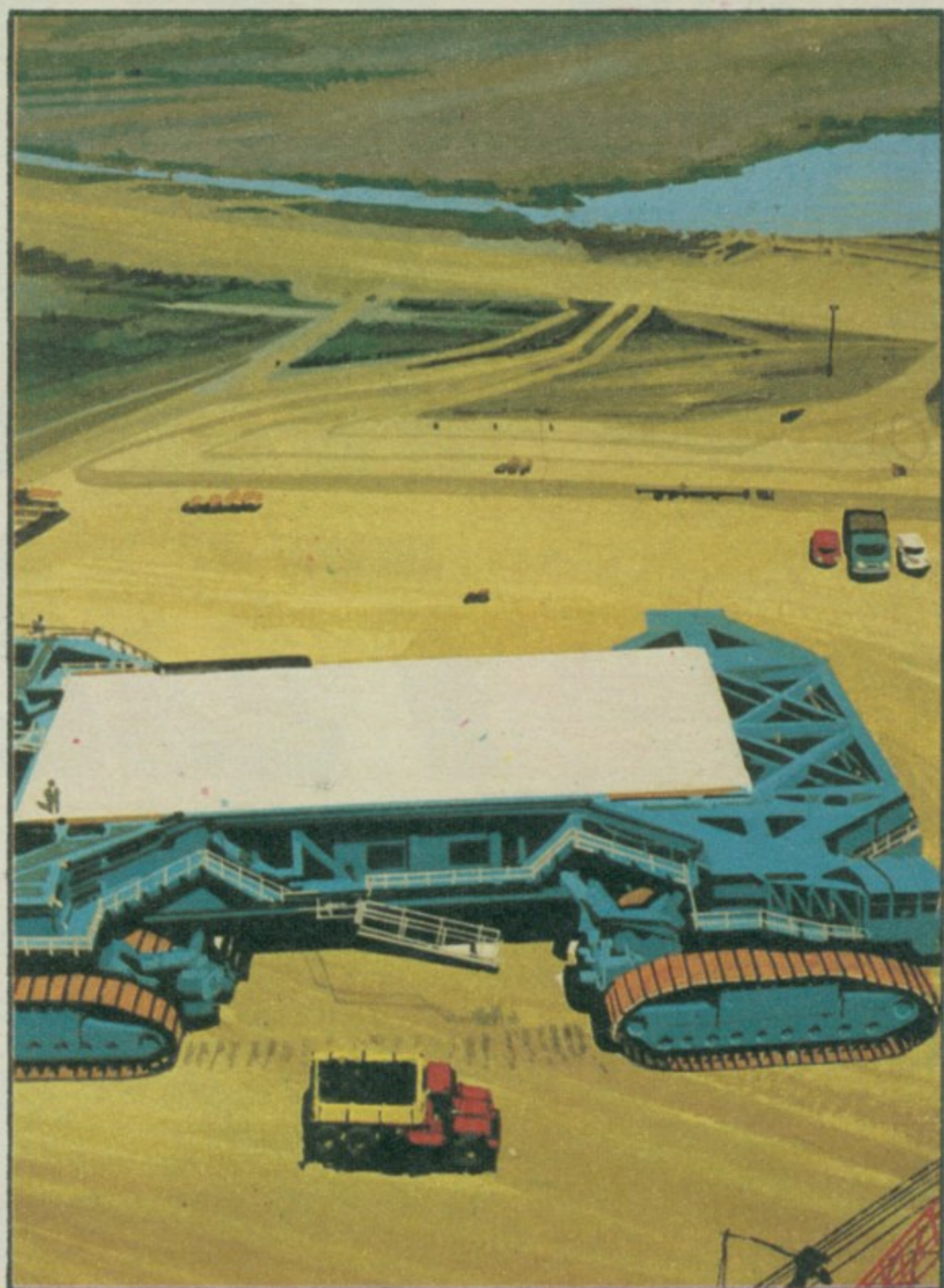
Џиновски носач са гусеница који покреће дизел-мотор јачине 2750 КС.
