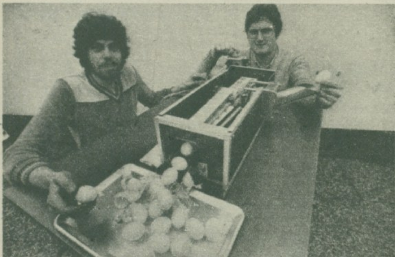
Прва машина на свету за љуштење куваних јаја, капацитета 3.000 јаја на час.
