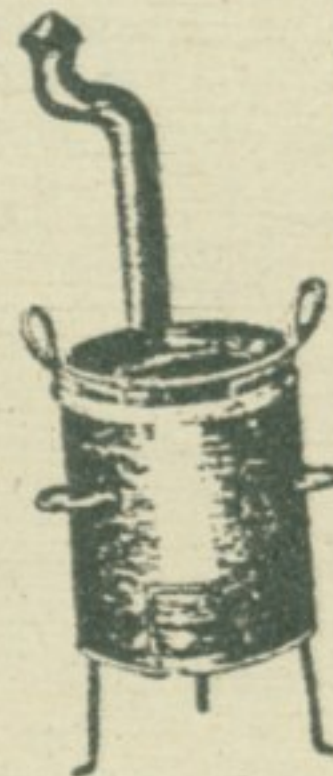
Slika br. 5 pokazuje kazan sa željeznom peći za pranje veša i topljenje masli.
