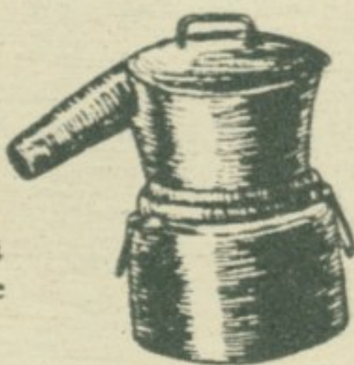
Slika br. 4 pokazuje kazan starinskog sistema sa širokim kapkom i pravom lulom za pečenje šljivovog i lozovog koma, a može biti razne veličine.
