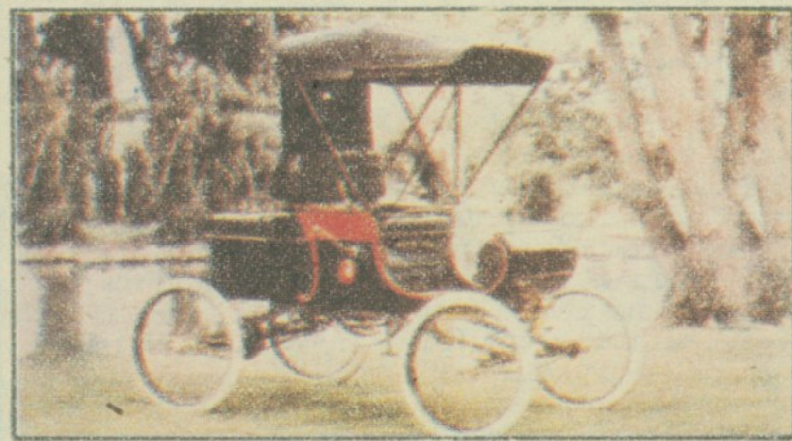
1902. Олдс Курад-даш. Двосед са генератором био је први ауто произведен у великој серији. Комада: 10 000! Једноцилиндраш је јурио 20 km на сат – кроз град.
