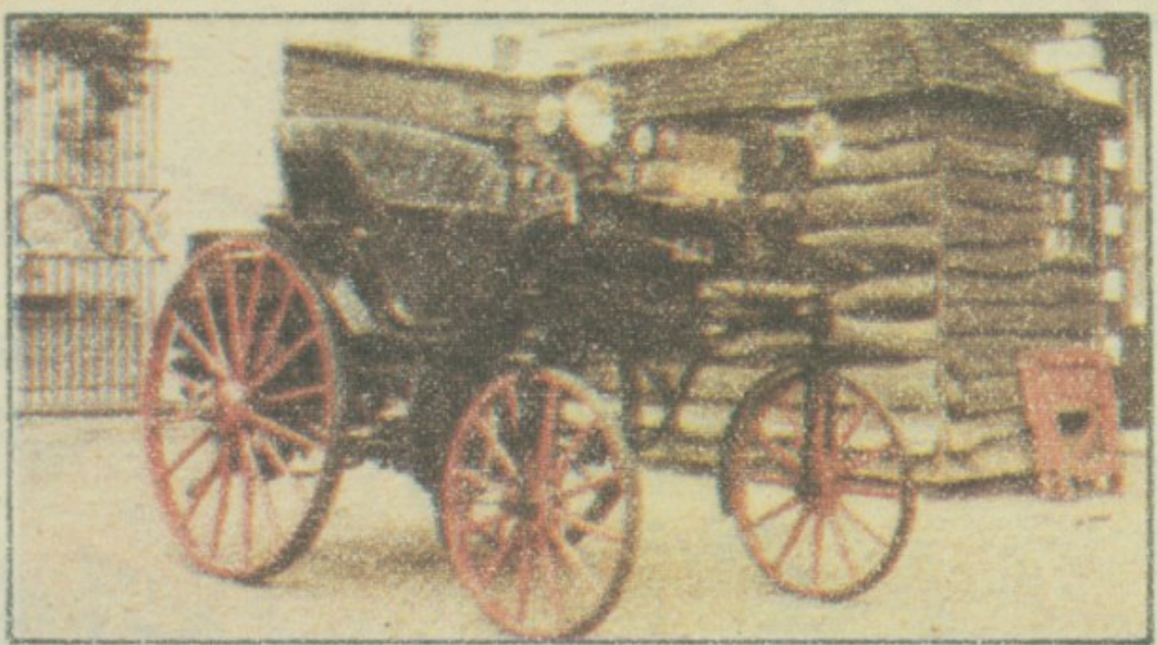
1896. Луцманова кола. После Дајмлера и Бенца овај Саксонец је био трећи Немац који је прaviо аутомобиле. Дволитарски, двоцилиндрични мотор од 4 коњске снаге. Од 1898. године постала је фирма Opel.
