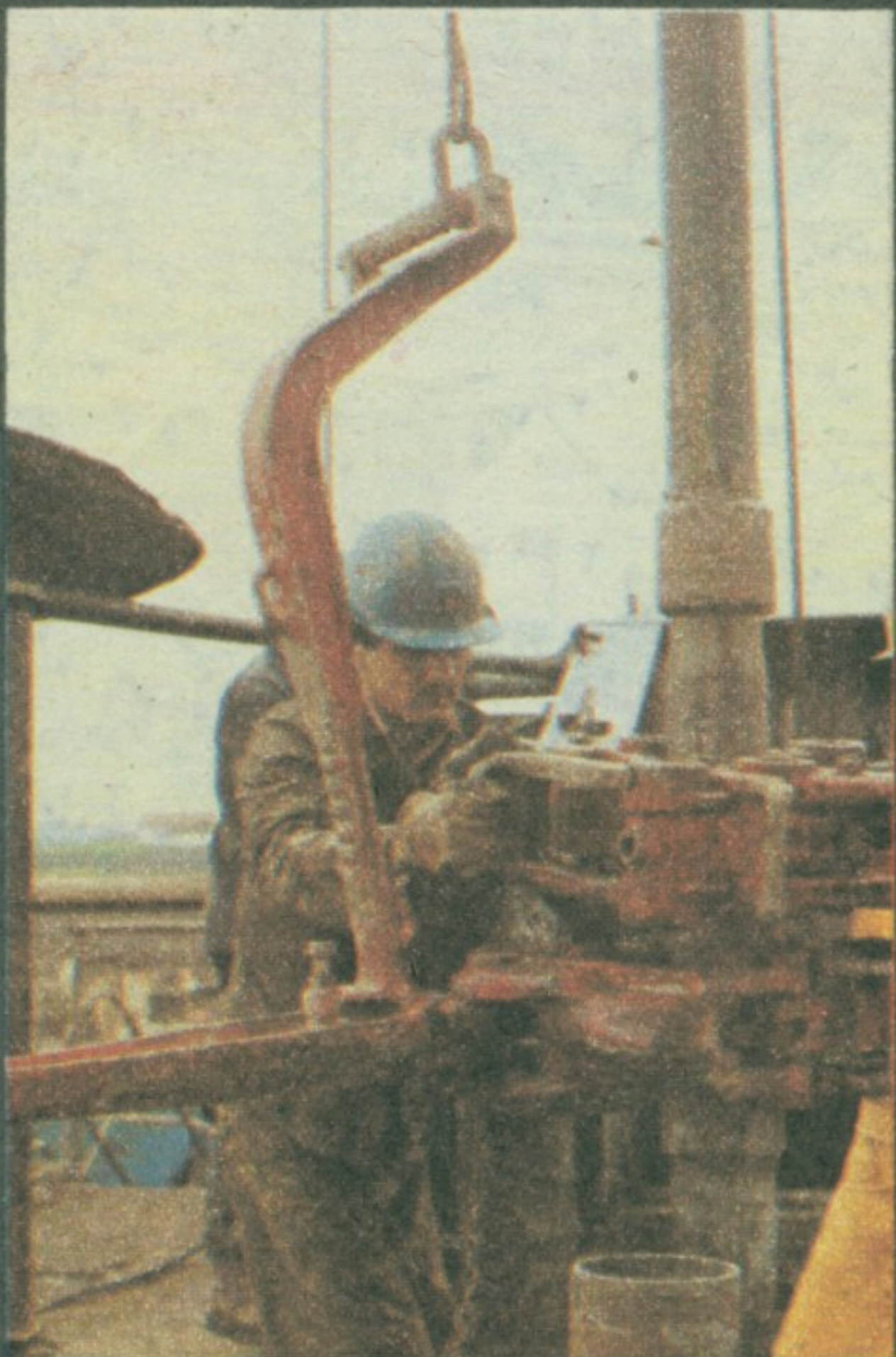
Да би челичне шипке стигле до дубине од 3500 метара, ваља њих стотинак добро затегнути. За то су задужени клинаши.
