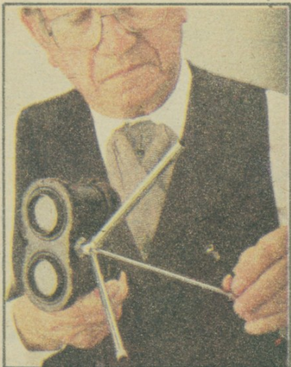
„Бинока опера глас камера“, дурбин за оперу, направљен у Јапану 1950. Фото-апарат је смештен између два сочива, а филм се крије у табlici са именом
