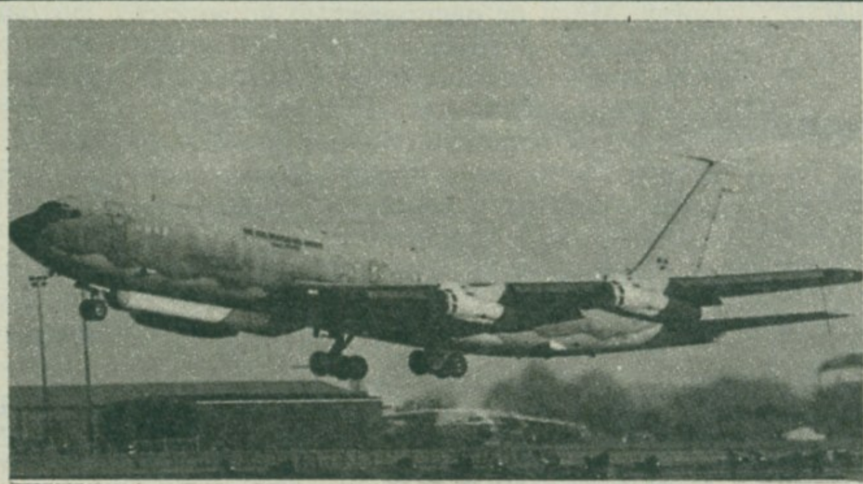
У избочини на доњем делу трупа преуређеног „боинга 707“ „Joint Star“ смештен је „Груманов“ радар за осматрање тла. Радар је показао такве резултате да га америчка војска већ сматра апсолутно незаменљивим
