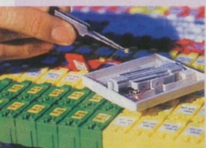
Електроника и генератор за самонапајање енергијом толико су мали да се могу извадити само алатом величине чиоде
