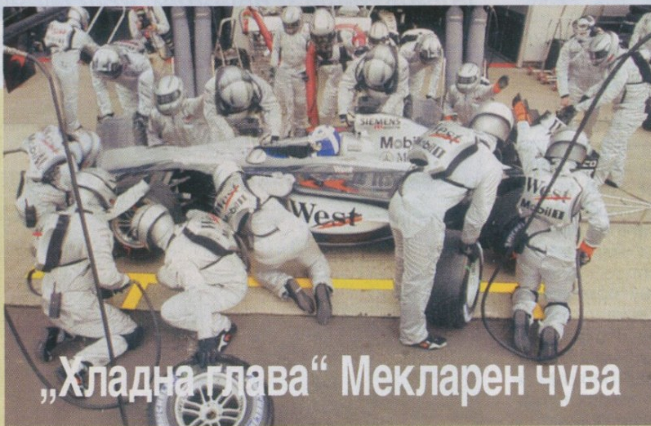
Лед у ранцу расхлађује ваздух који струји кроз радну одећу „Мекларенових“ механичара
