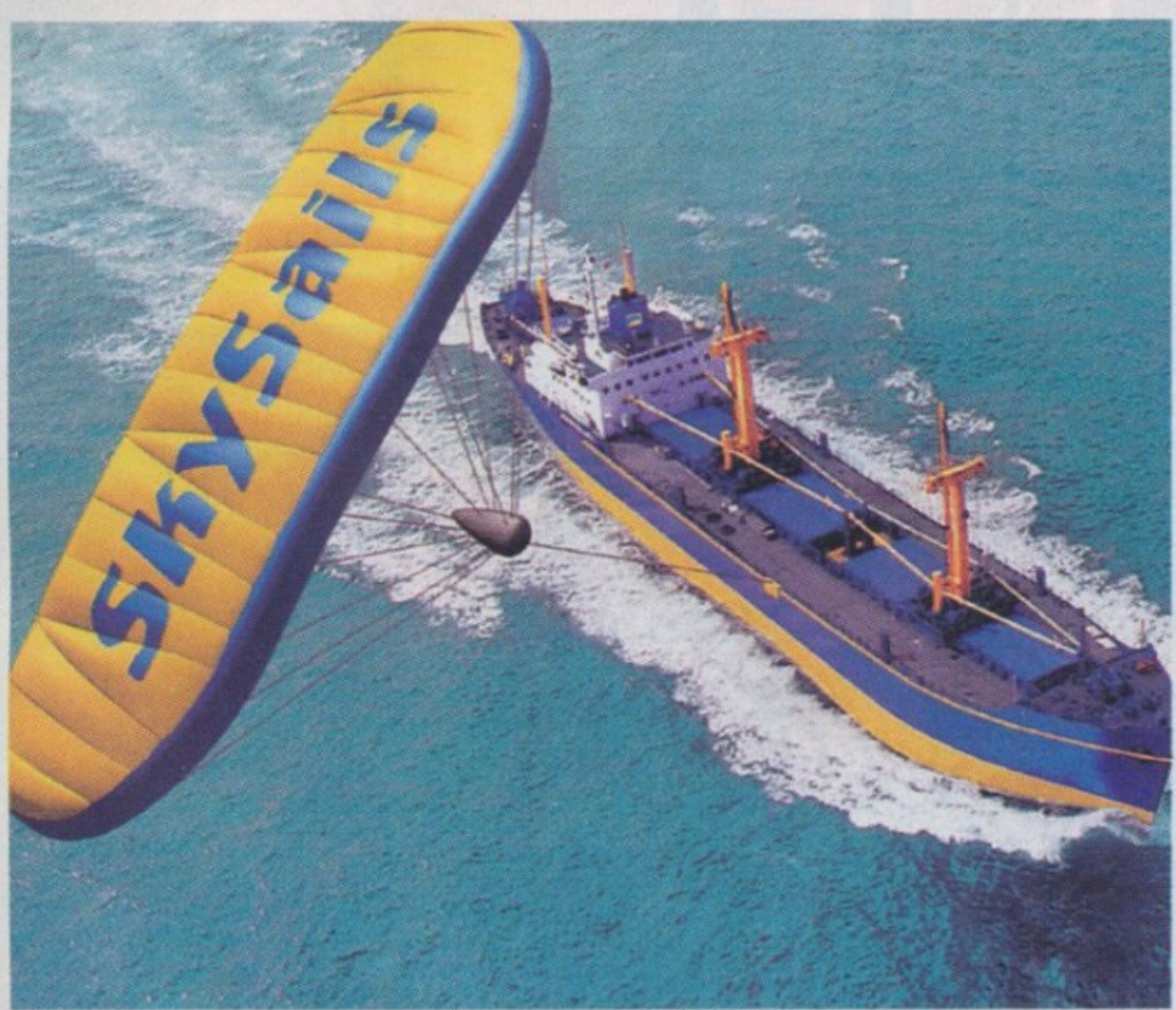
Без моторног постројења и погонског горива, велики танкери пловиће морима и океанима ношени снагом ветра заробљеног у „Небеском једру“
