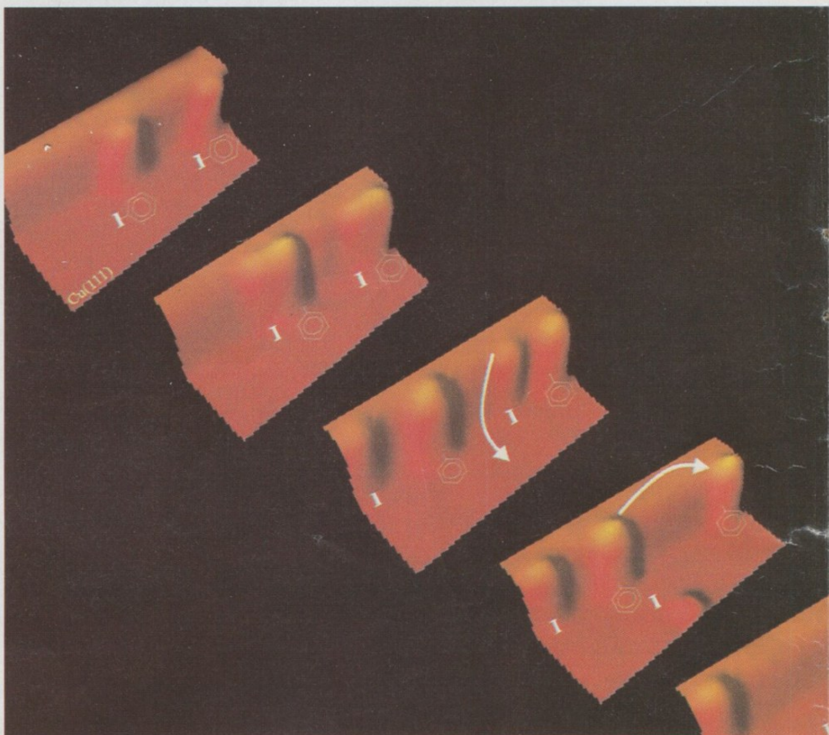
Ове снимке приказала је у часопису „Physical Review Letters“ септембра 2000. године једна екипа научника из Берлина. Они су доказ прве успешно изведене хемијске реакције помоћу микроскопа са тунел ефектом – од два молекула јодобензена добијен је молекул дифенила и два атома јода.
