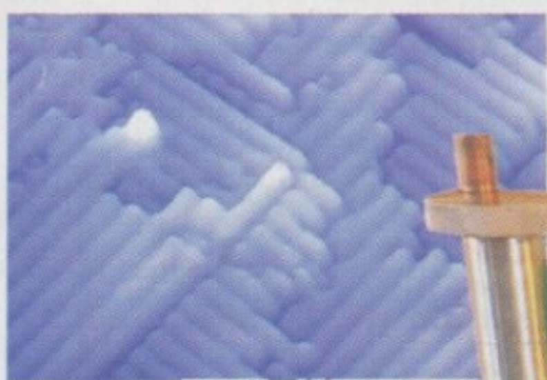
На снимку је кристална мрежа једног дијаманта прекривеног водоником.
