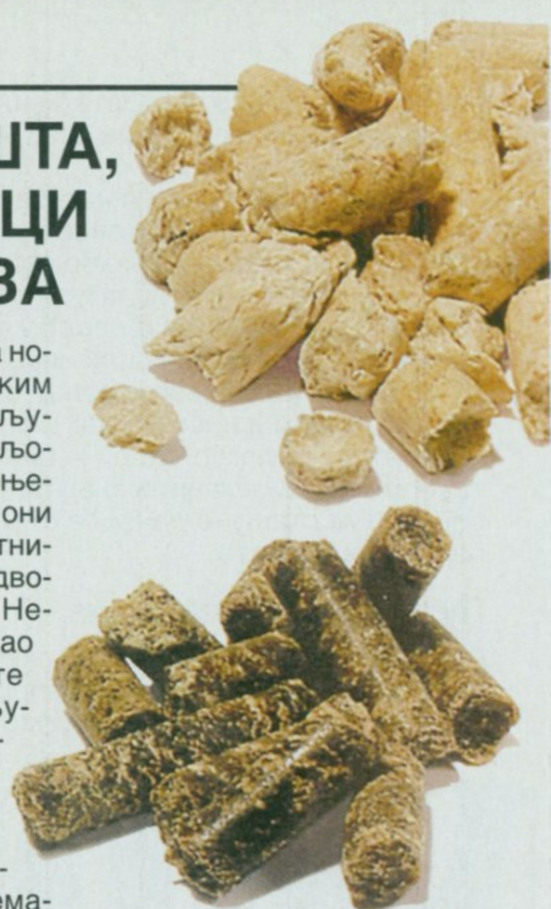
Тамни ваљчићи од самлевених и пресованих отпадака житарица (тамни) имају много већу енергетску вредност од оних направљених од пиљевине дрвета (светли).
