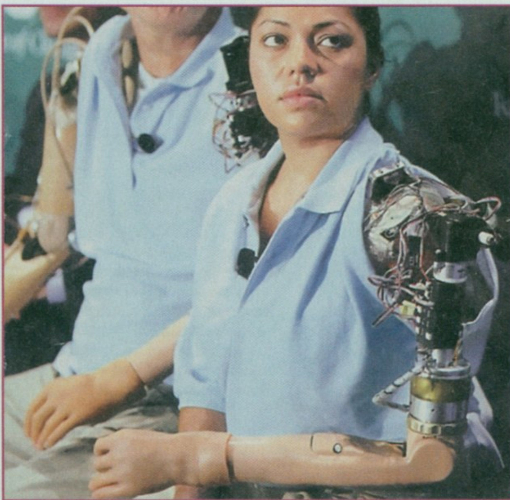
Двадесетшестогодишња Американка Клаудија Мичел има уграђену бионичку руку. Моторика покрета није само механичка, већ их девојка и осећа захваљујући неуросензорима који и примају и прослеђују импULSE ка мозгу и из њега.
